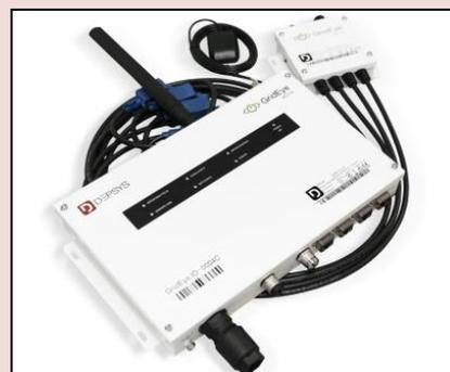
*Werden dezentral im Verteilnetz installiert: die Mess- und Steuereinheit MCU100 und die Strommessereinheit SUR100. Die Geräte verfügen außerdem über eine „dezentrale Intelligenz“: Ihre integrierte Steuereinheit kann regelbare Ortsnetzstationen, Erzeuger oder Lasten steuern und so zur Stabilität des Verteilnetzes beitragen.*
