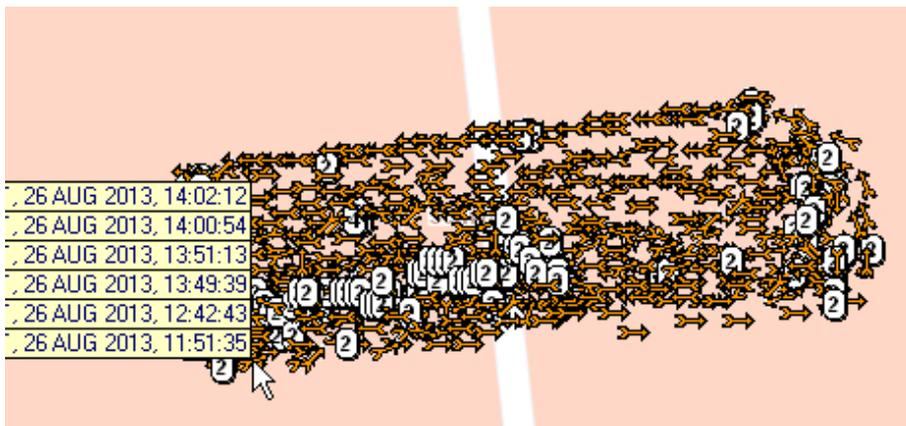
Mit telematikbasierter Technik sind die Kehrstrecken nicht exakt zu ermitteln, da die Strecken teilweise sehr kurz sind und die Kehrgeschwindigkeit unter fünf Stundenkilometer liegt. (Abbildung: rona:systems)
