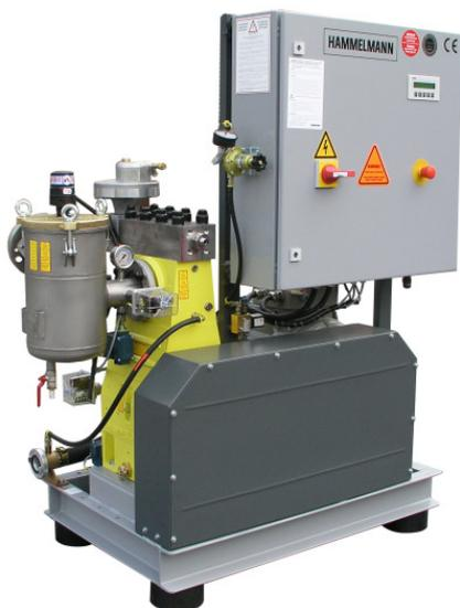
Die stufenlos regelbare Hochdruckpumpe wird von der Steuerung CNC300ET direkt angesteuert. (Foto: Hammelmann Maschinenfabrik GmbH)
