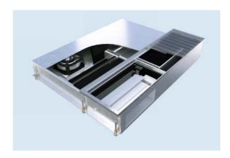
Das neue Fassadenlüftungsgerät FVP*pulse* der LTG wechselt zyklisch zwischen Zu- und Abluftbetrieb (Ein- und Ausatmen). Ein Klappensystem steuert dabei die Luftrichtung. Vorteil des Prinzips: Hohe Luftfördervolumina trotz des kleinen Gehäuses, effektive Wärmerückgewinnung inklusive Vereisungsschutz, nur eine statt zwei Fassadenöffnungen und – last but not least – die Möglichkeit, Bürogebäude instationär zu lüften.
