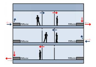
Der Einsatz mehrerer FVP*pulse* in einem Objekt mit Überströmöffnungen zu den Fluren ermöglicht ein "atmendes Gebäude". Der so resultierende instationäre Luftaustausch ist einer natürlichen Luftbewegung sehr ähnlich und wird daher von Gebäudenutzern als angenehm empfunden.
