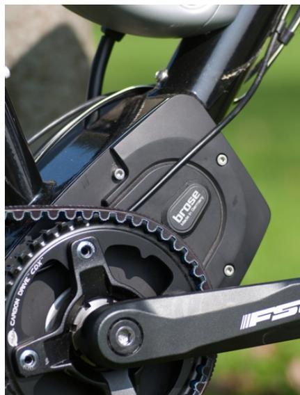
Das flitzbike „traveller“ kombiniert Leistungsstärke mit Wartungsarmut: brose-Mittelmotor mit Riemenantrieb von Gates Carbon Drive. (Foto: flitzbike)
