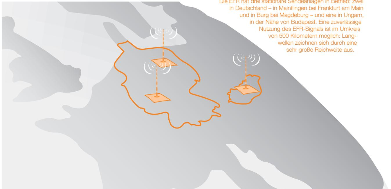
Die EFR hat drei stationäre Sendeanlagen in Betrieb: zwei in Deutschland – in Mainflingen bei Frankfurt am Main und in Burg bei Magdeburg – und eine in Ungarn, in der Nähe von Budapest. Eine zuverlässige Nutzung des EFR-Signals ist im Umkreis von 500 Kilometern möglich: Langwellen zeichnen sich durch eine sehr große Reichweite aus.
