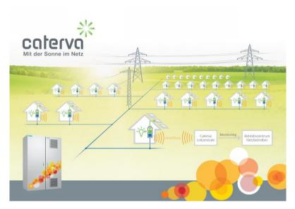
Im Projekt SWARM sind die in Eigenheimen aufgestellten 65 PV-Stromspeicher "Caterva-Sonne" zu einem Verbund zusammengeschaltet, der Regelleistung zum Stabilisieren des Stromnetzes bereitstellt. Gleichzeitig können die Haushalte dank der Speicher erheblich mehr von ihrem selbst erzeugten PV-Strom für sich nutzen.
