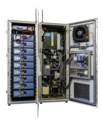
Hauptkomponenten der Stromspeicher Caterva-Sonne im Projekt SWARM sind die Lithium-Ionen-Akku-Module (linke Geräteseite) und die Leistungselektronik sowie die Kommunikations- und Steuerungstechnik (rechte Seite).
